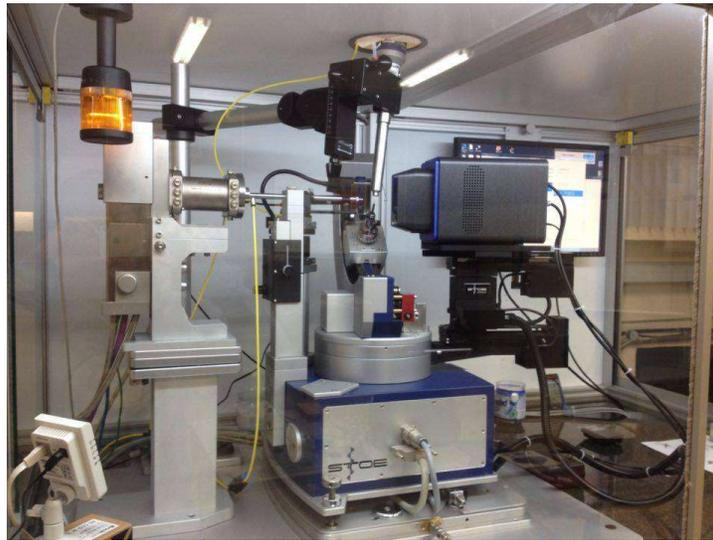
*Ilustración 3 Difractómetro de cristal único Stoe Stadivari, IFUAP.*
