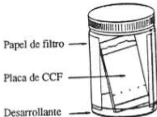
Fig. 4 Cromatografía en capa fina, la placa esta inclinada, la muestra sembrada en el extremo y el disolvente, esto se da en forma descendente
