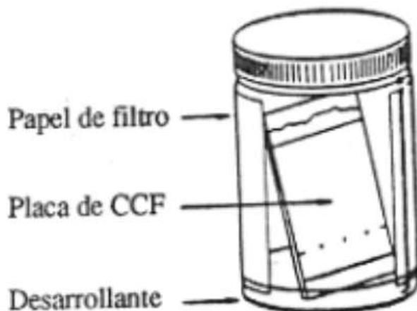
*Imagen 1.6* revelado de placas de cromatografía de capa fina.
