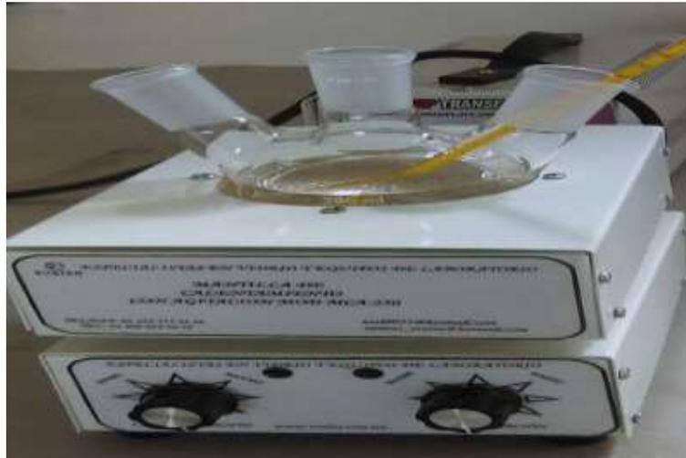
Fig. 10. Evaporación del disolvente
