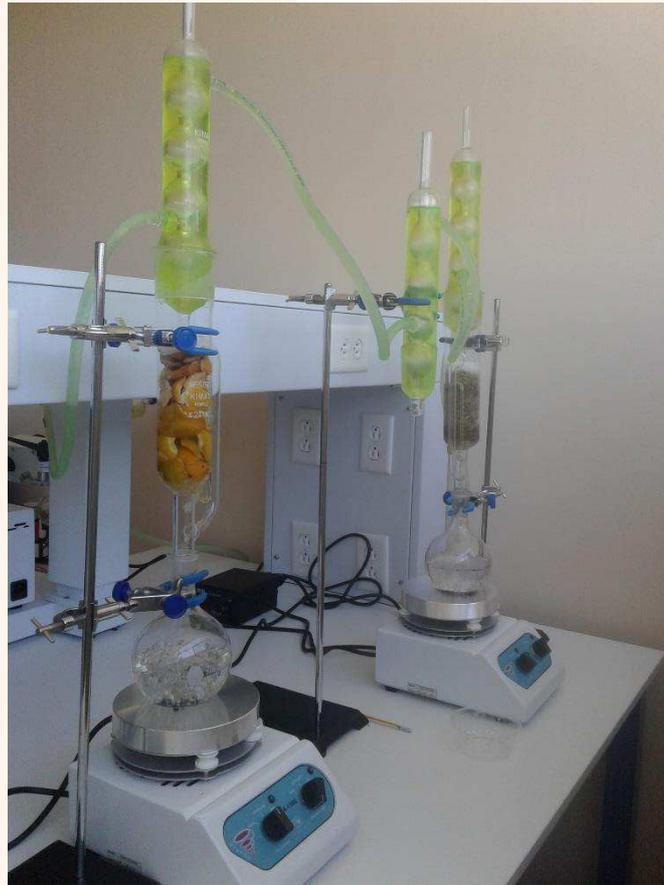
Imagen 10. Equipo de extracción Soxhlet
