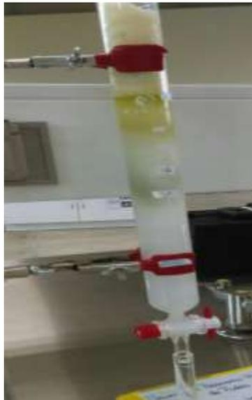
Fig. 9. Recorrido del analito con hexano/acetato 9:1
